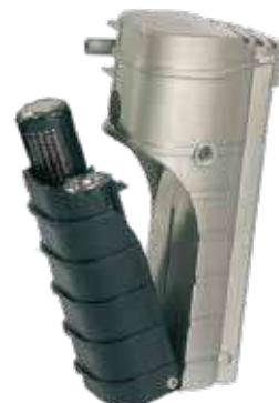
パンプテストまたは校正は、同じガスと同じ検知範囲のMicro IVに対してのみ実行できます。これらのパラメーターの変更は、校正ソフトウェアを介して実行できます。DS220は、O<sub>2</sub>、CO、H<sub>2</sub>S、SO<sub>2</sub>、およびH<sub>2</sub>校正ガスでのみ使用できます。
