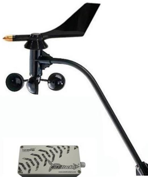
風速/風向データロガーWindTracker-Pro は風力発電機の設置場所を検討するために開発された、風速/風向データロガーです。
