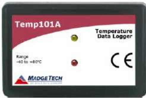
TEMP101A は小型ミニチュアサイズで、電池で作動する高精度の温度データロガーです。本体内部には高精度な側温抵抗体(RTD)を使用しており、温度精度は±0.5°Cです。
