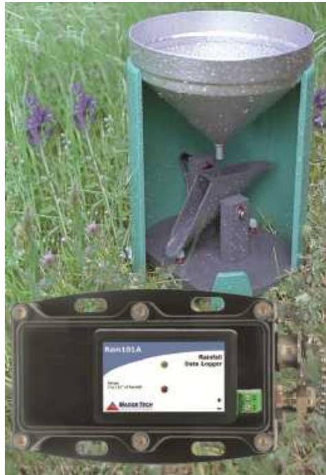
雨量データロガー Rain101A は長期間にわたり降雨量を正確に測定記録できるシステムです。システムは全天候型ケース入りパルスデータロガー、転倒ます雨量計とデータロガー接続ケーブル 15m の組み合わせとなります。
