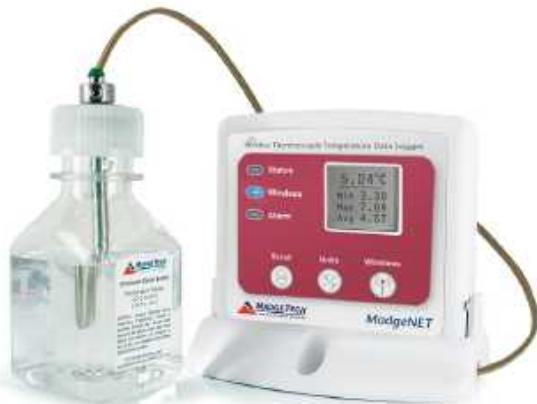
ワクチン保管温度管理用ワイヤレス温度ロガー RFVTMS は、外部温度に熱電対センサーを使用する温度データロガーです。センサーは実際のワクチン温度を測定できるように、グリコールが入っているボトル内に挿入されています。RFVTMS は 1 秒 ~ 24 時間の間で指定した測定間隔で測定中の温度をパソコンに転送し、同時に本体内部メモリーに温度データを測定日時とともに保存します。
