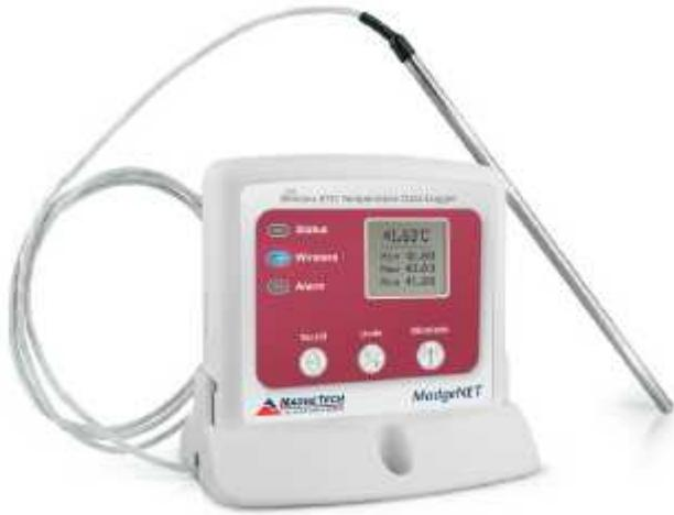
ワイヤレス温度ロガーRFRTDTemp2000A は、21,504 メモリーを有する高精度な温度データロガーです。RFRTDTemp2000A は 1 秒～24 時間の間で指定した測定間隔で測定中の温度データをパソコンにリアルタイムで転送し、同時に本体内部メモリーに温度データを測定日時とともに保存します。
