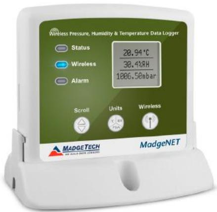
ワイヤレス温湿度・気圧ロガーRFPRHTemp2000A は、10,752 メモリーを有する温湿度・気圧データロガーです。RFPRHTemp2000Aは1秒~24時間の間で指定した測定間隔で測定中の温湿度・気圧データをパソコンにリアルタイムで転送し、同時に本体内部メモリーに温湿度・気圧データを測定日時とともに保存します。
