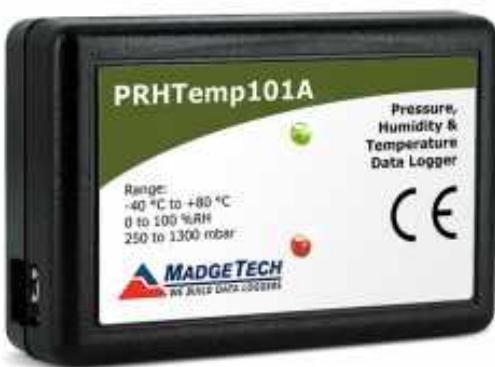
PRHTEMP101A は、気圧・温度と湿度を同時に測定記録できるデータロガーです。メモリー数は 1 チャンネル 688,128 と大きく長期間の測定に対応できます。
