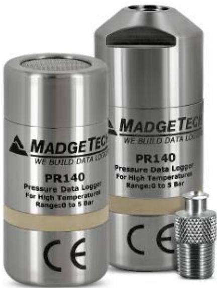
圧力ロガーPR140 は、+140°Cの高温下で連続使用できる圧力データロガーディ。圧力センサーにはセミコンダクタストレインゲージ 0 を使用しており測定精度は±0.03 Bar と高精度です。
