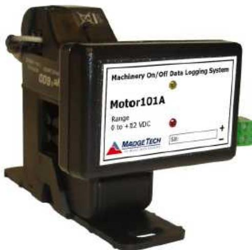
データロガー Motor101A は 200 アンペアまでのモーターや機械の On/Off 状態を記録する新しいデータロガーシステムです。Motor101A は電流スイッチが付属しており、モーターや機械の電流値が予め設定されている 150 mA を超過又は下回ったときに On/Off 状態を自動記録します。
