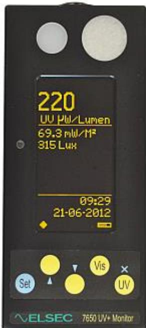
環境測定器 LUV-7650C は一台で照度、紫外線強度を同時に測定表示できる環境測定器です。
