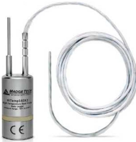
温度ロガー HiTemp140X2-TD-FP は、32,767 メモリーを有する温度データロガーで、同時に 2ヶ所の温度測定に対応できます。温度センサーには白金抵抗体 Pt-100 を使用しており測定精度は  $\pm 0.1$  と高精度です。
