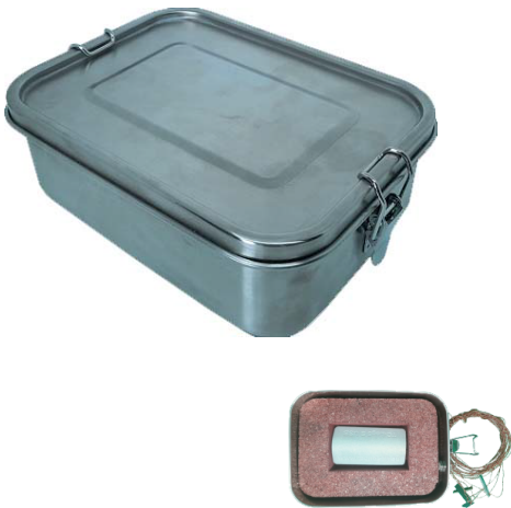
K タイプ 熱電対を使用します。 熱電対の接続はデータロガー本体内部で結線し小型化
