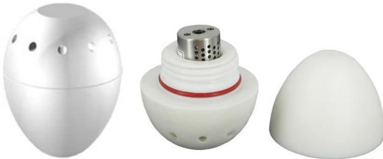
EggTemp-RH は卵の温度管理に特別に設計された温湿度データロガーです。EggTemp-RH は実際の卵と同じに温度と湿度を検知測定できるようにデザインされております。
