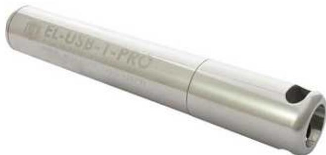
EL-USB-Pro は、最大 32,510 の測定データをメモリーすることができる高温耐熱完全防水構造 IP67 適合の温度データロガーです。本体は SUS316 製で酸やアルカリにも強く、そのうえ、+125 の高温環境下での連続使用が可能です。
