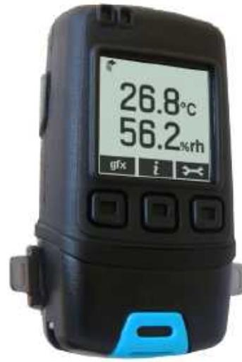
デジタル表示付き温湿度データロガー EL-GFX-2 は、メモリー数が 250,000 と膨大で長期間にわたり温湿度を測定できる完全防水構造 IP67 適合の温湿度ロガーです。
