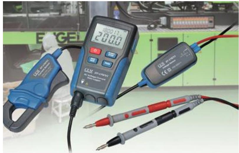
国際的な安全基準IEC61010に準拠したデザインで組み立てられているDT-175CV1は、一台で交流電圧と交流電流の測定に対応しているデータロガーです。
