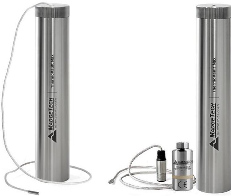
DHS システムは温度ロガー HiTemp140-M12 と SUS 製の高温耐熱ケースを使用した、超高温温度モニタリングシステムです。HiTemp140-M12 の温度センサーには白金抵抗体 Pt-100 を使用しており測定精度は-200 ~+400°C の間で±1.2°C と高精度です。
