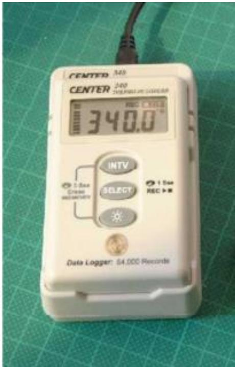
温度ロガーCENTER 340 は防水構造 IP 65(暴噴流型)適合の温度データロガーです。
